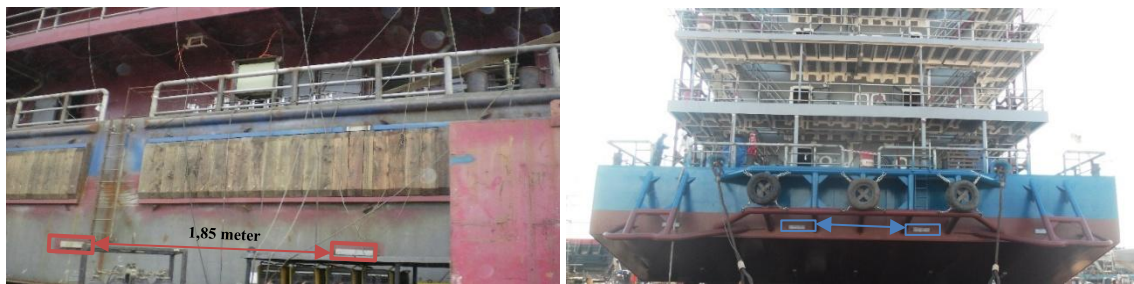
Gambar 3. Jarak Aktual Pemasangan Anoda Lambung Elnusa Samudera 8 Accommodation Barge. Sumber: Dokumentasi penulis, 2025
