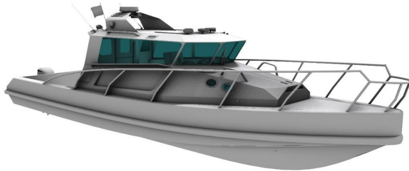
Gambar 2. Model 3D Kapal Riset HPDE
