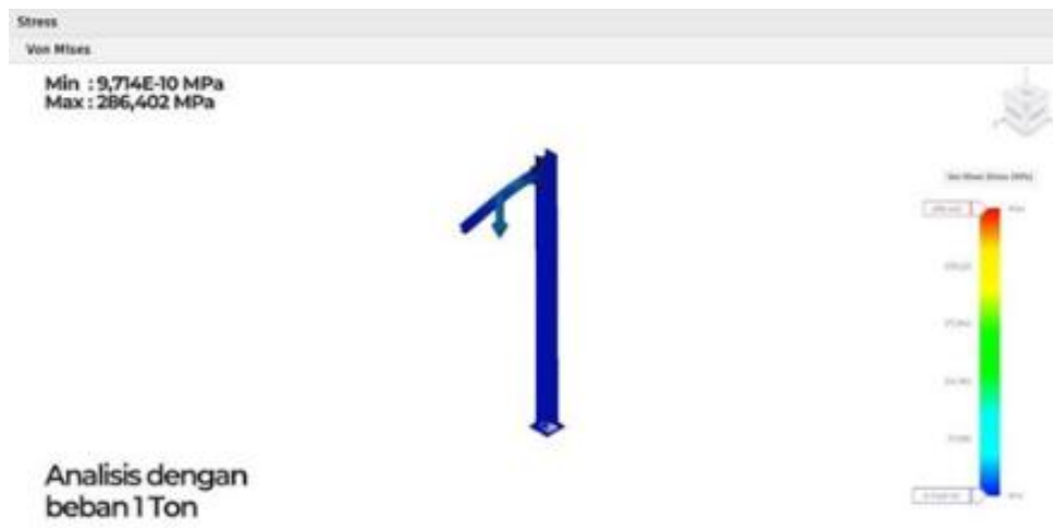
Gambar 5. Hasil Simulasi Stress pada beban 1000 kg
