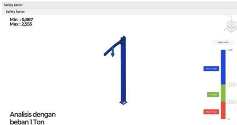
Gambar 7. Hasil Simulasi Safety factor pada beban 1000 kg
