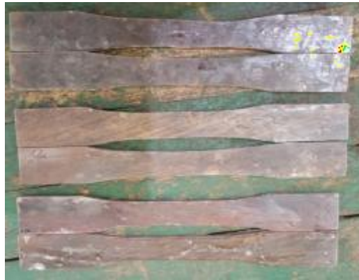
Gambar 1. Spesimen Uji Tarik
