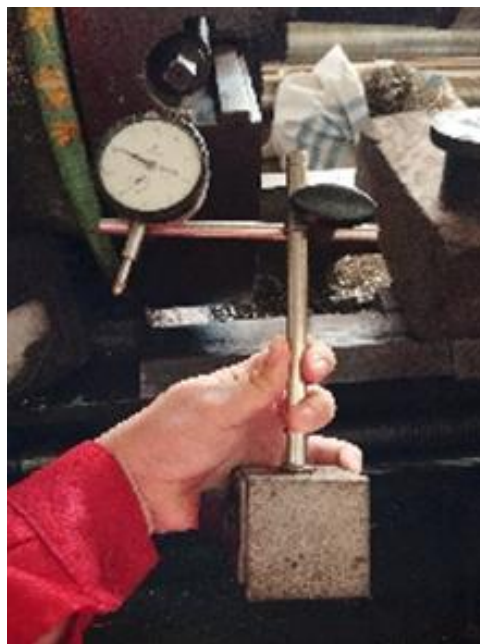
Gambar 3. Dial Gauge (Sumber: dokumentasi pribadi)
