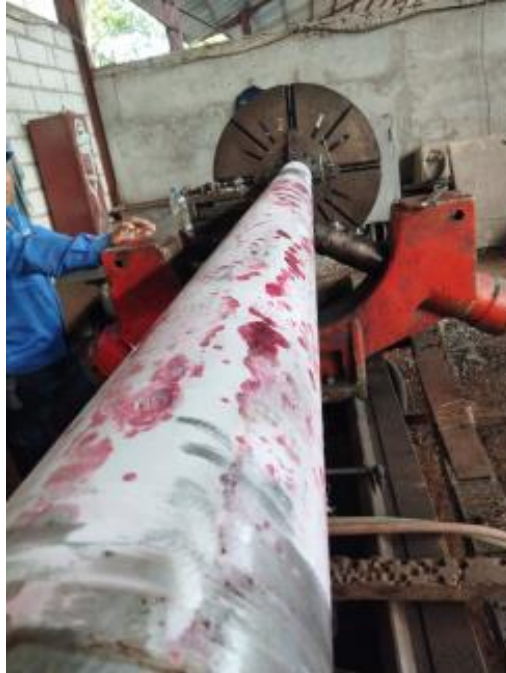
Gambar 4. Proses uji kelurusan pada poros baling-baling (Sumber: dokumentasi pribadi)
