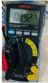
Gambar 13 Hasil Pengukuran Frekuensi encoder
