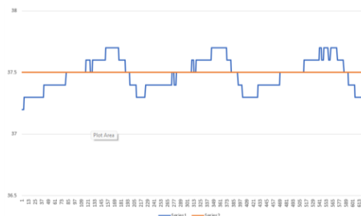
Gambar 9. Hasil Pengetesan pada K_p = 2,0 ; K_i = 0,4 ; K_d = 3,2
