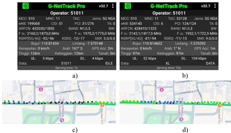
Gambar 10. (a) & (c) Hasil & lokasi pengukuran TSEL di Jl. Kebangkitan Nasional, (b) & (d) Hasil & lokasi pengukuran XL di Jl. Kebangkitan Nasional
