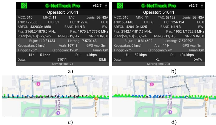
Gambar 14. (a) & (c) Hasil & lokasi pengukuran TSEL di Jl. Kebangkitan Nasional (b) & (d) Hasil & lokasi pengukuran XL di Jl. Kebangkitan Nasional
