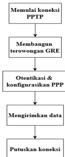
Gambar 4. Blok Diagram Cara Kerja PPTP
