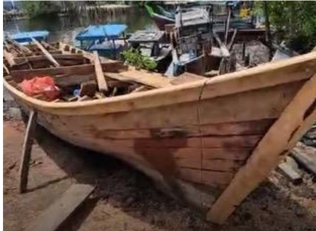
Gambar 4. Linggi haluan kapal telah di ganti dengan kayu rusak
