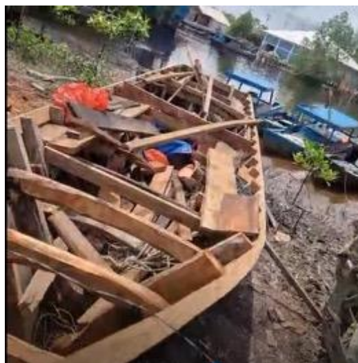
Gambar 5. Perbaikan Senta geladak kapal nelayan Citra
