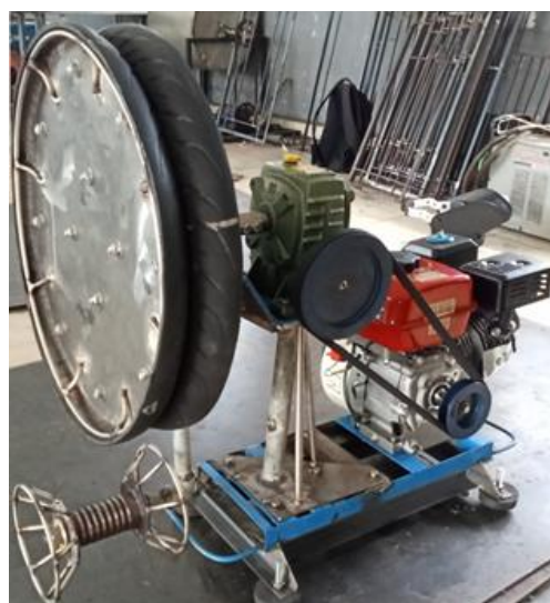
Gambar 3.2 Konstruksi 1 unit alat penarik jaring nelayan dengan penggerak motor bensin dengan gear box sebagai robot penarik jaring
