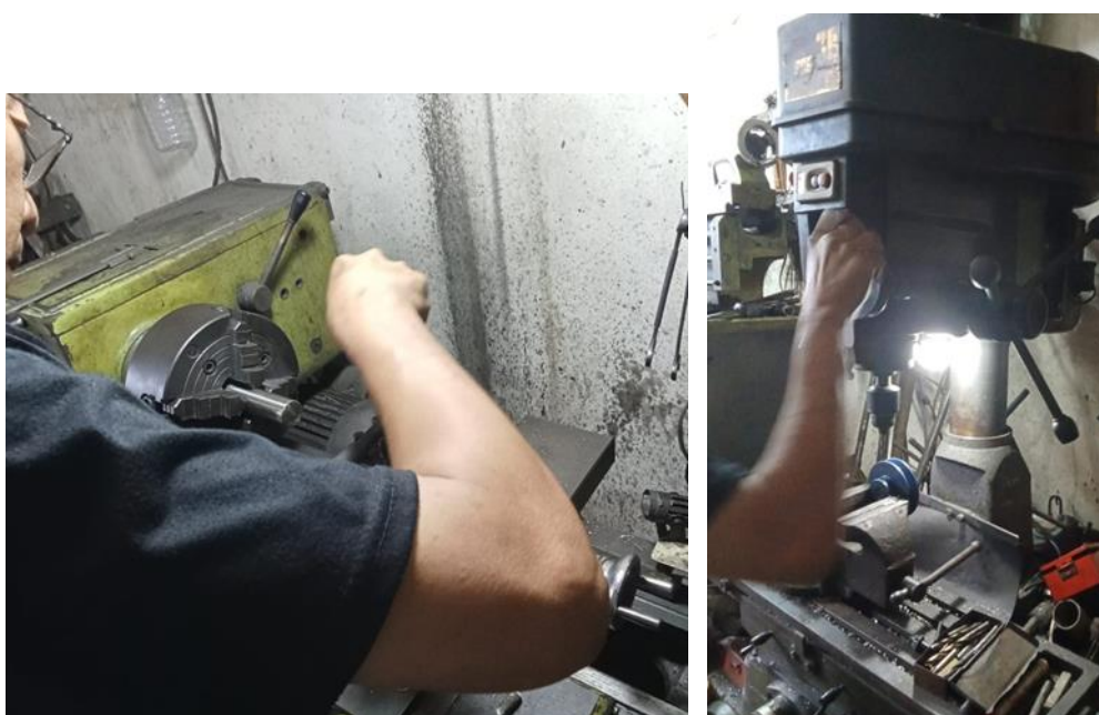
Gambar 3.4 Proses pembubutan poros roller penarik dari bahan stainless steel 304 berdiameter 31 mm dan pembuatan alur pasak pada puli
