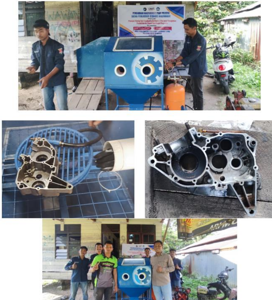
Gambar 4. Pelatihan penggunaan alat dan penyerahan sandblasting 20 Bar. (Firman Alhaffis & Alfansuri, 2025)
