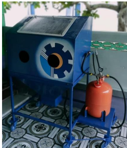
Gambar 3. Sandblasting kapasistas tekanan 20 Bar.
