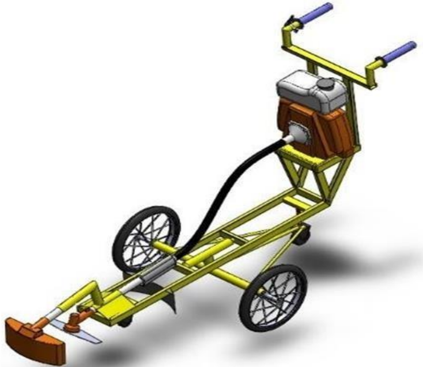
Gambar 4 Mesin Pemotong Rumput Gendong Menjadi Tipe Dorong
