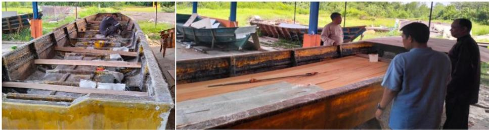
**Gambar 6** Pemasangan papan sebagai lantai kapal
