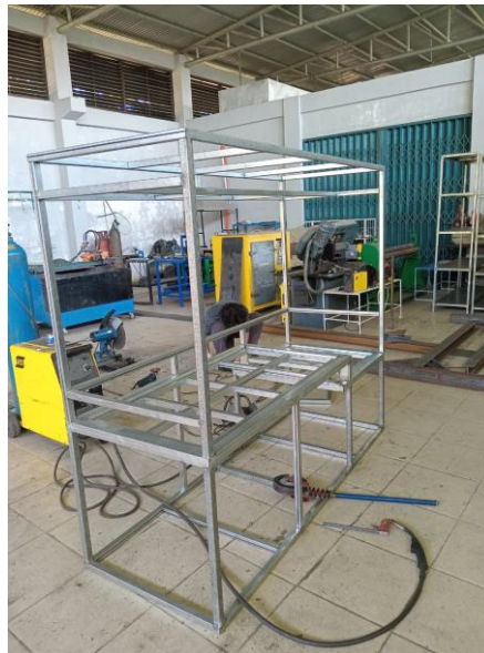
Gambar 5. Pemasangan keseluruhan Rangka utama (sumber : foto dokumentasi)
