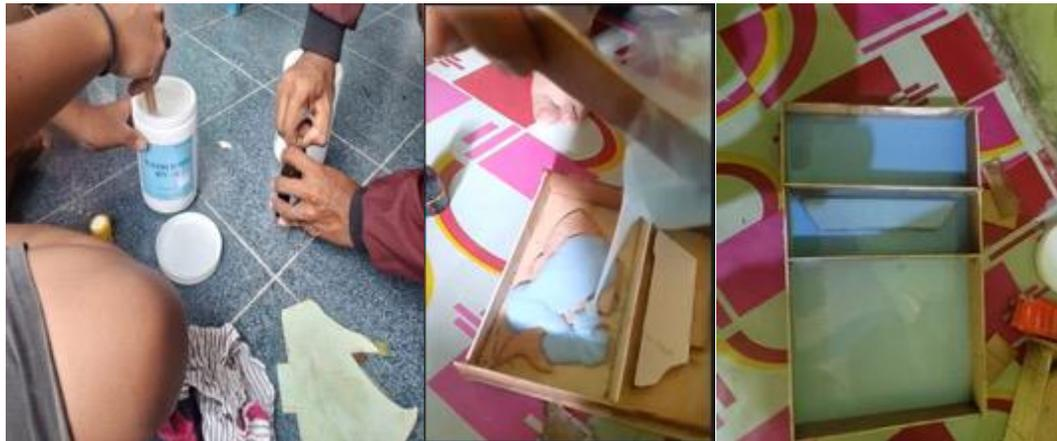
Gambar 6. Penuangan Silicon Rubber pada Wadah Cetakan
