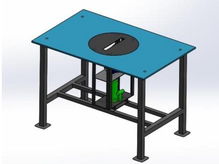
Gambar 4. Mesin pemotong dan meratakan permukaan kayu
