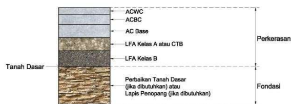
Gambar 2 Komponen Struktur Perkerasan Lentur
